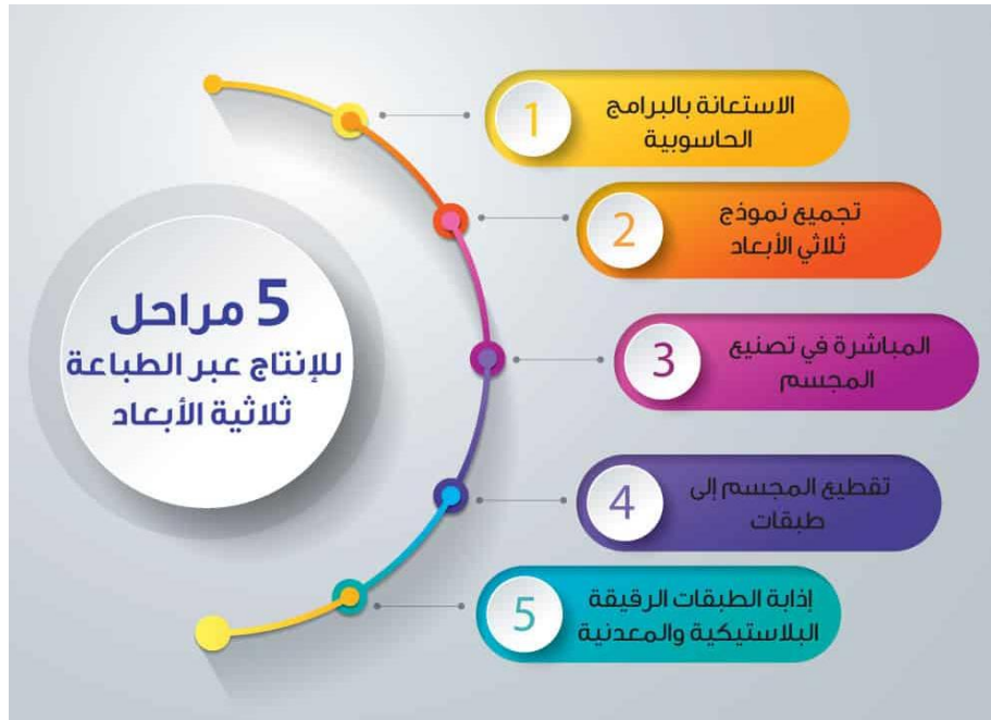
شكل يوضح مراحل الطباعة ثلاثية الأبعاد
